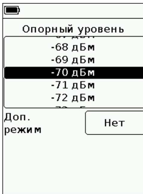
Рисунок 8.4.1 – Установка опорного уровня входного сигнала
