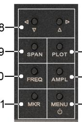
8. Кнопки перемещения маркеров, перемещение по частоте и амплитуде, изменение диапазона сканирования.
