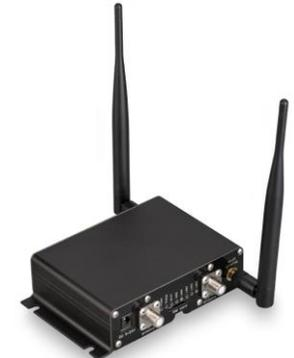
Роутер работает с SIM-картой любого 3G и 4G/LTE оператора в поддерживаемых частотах (YOTA, Мегафон, МТС, Билайн, Ростелеком, Tele2).
