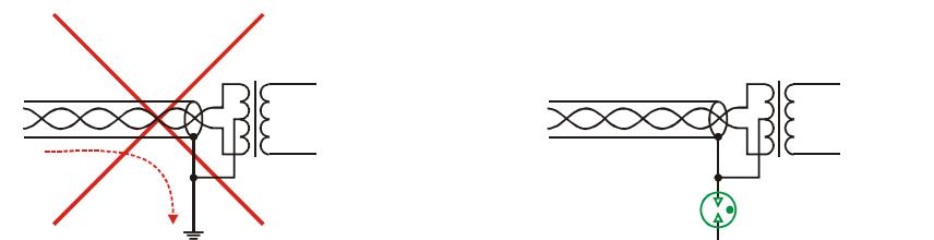
3. Цель подавления помехи обеспечивает нейтрализацию импульсной помехи, возникающей при срабатывании газоразрядного прибора.
