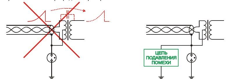
4. Шунтирующее газоразрядное прибора высокомоментным резистором обеспечивает "мягкое" стекание электростатических зарядов, оседающих на кабельном сегменте при выпадении осадков и индуцируемых грозовыми облаками. Это снижает нагрузку на газоразрядный прибор и уменьшает потери данных в условиях высокой напряженности электростатических полей.
