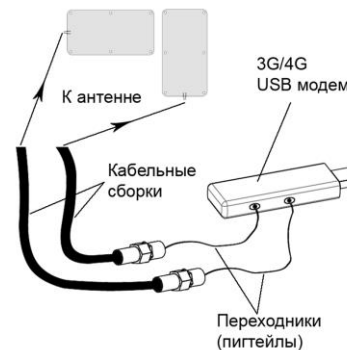
Схема 1 – Подключение антенны к USB модему
