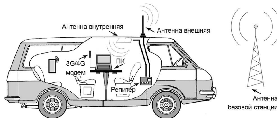
Схема 2 – Пример расположения антенны в салоне микроавтобуса при работе с репитером
